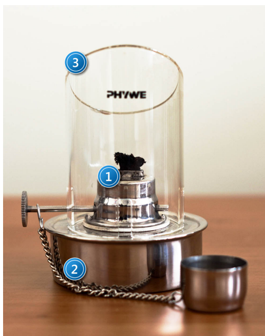
Zdjęcie 3. Widok palnika: 1 – nakrętka; 2 – zbiornik; 3 – komin palnika.
