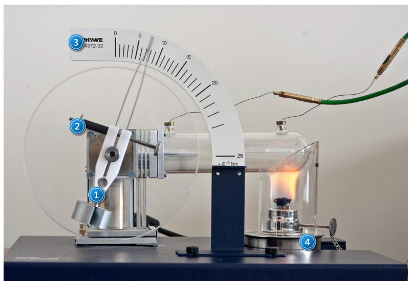
Zdjęcie 2. Uruchomiony silnik Stirlinga: 1 – miernik momentu obrotowego; 2 – śruba zaciskowa miernika; 3 – skala miernika; 4 – palnik z kominem.
