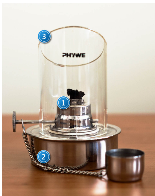
Zdjęcie 3. Palnik wraz z kominem: 1 – nakrętka palnika; 2 – zbiornik palnika; 3 – komin.
