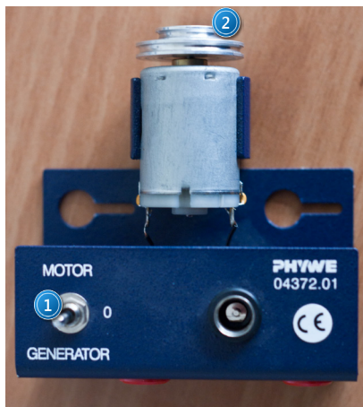
Zdjęcie 3. Moduł generatora: 1 – przełącznik trybu pracy; 2 – koła pasowe na generatorze.
