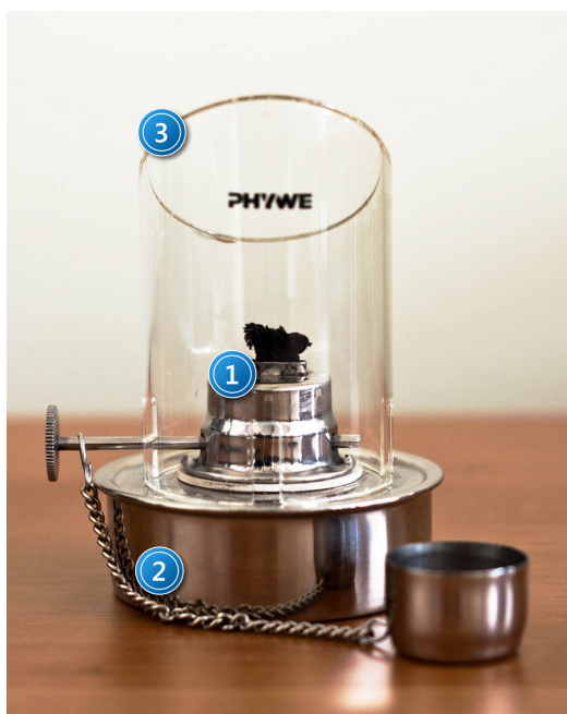
Zdjęcie 4. Palnik: 1 – nakrętka palnika; 2 – zbiornik palnika; 3 – komin palnika.
