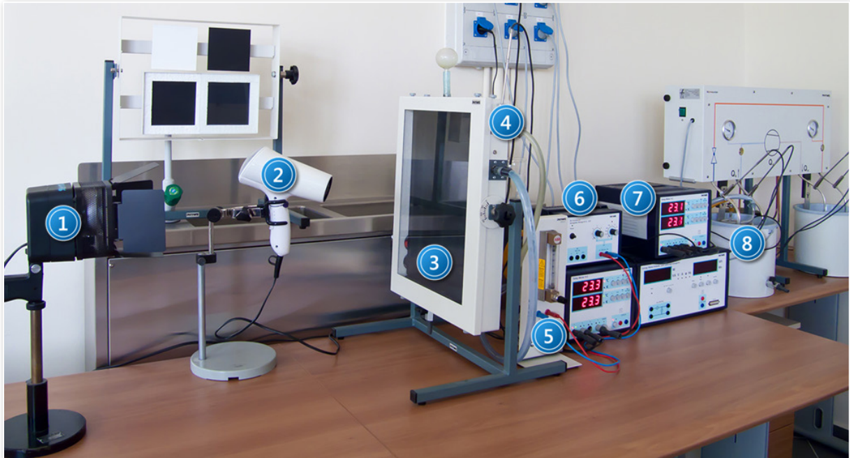
Zdjęcie 1. Stanowisko pomiarowe do badania własności kolektora słonecznego: 1 – lampa halogenowa o mocy 1 kW; 2 – suszarka; 3 – kolektor słoneczny; 4 – sonda termoelektryczna; 5 - pompa wodna z miernikiem przepływu; 6 – zasilacz pompy wodnej; 7 – cyfrowy miernik temperatury; 8 – rezerwuuar z wymiennikiem ciepła.
