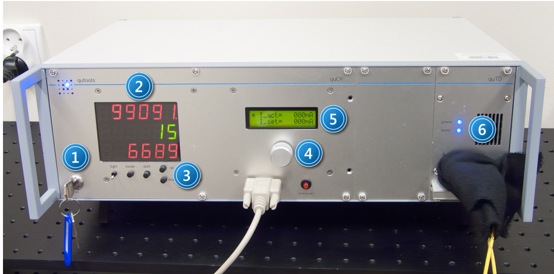
Zdjęcie 7. Jednostka pomiarowa : kontroler –wielofunkcyjny zasilacz - detektor pojedynczych fotonów: 1 – główny włącznik modułu; 2 – wyświetlacz zliczeń; 3 – przyciski funkcji licznika; 4 – pokrętło zmiany parametrów lasera; 5 – wyświetlacz ustawionych parametrów lasera; 6 – wskaźniki stanu pracy modułu APD.
