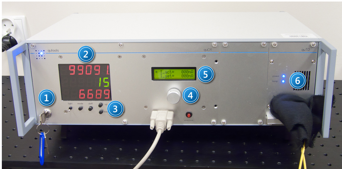
Zdjęcie 5. Jednostka pomiarowa – kontroler, wielofunkcyjny zasilacz, detektory pojedynczych fotonów: 1 – główny włącznik modułu; 2 – wyświetlacz zliczeń; 3 – przyciski funkcji licznika; 4 – pokrętko zmiany parametrów lasera; 5 – wyświetlacz ustawionych parametrów lasera; 6 – wskaźniki stanu pracy modułu APD.
