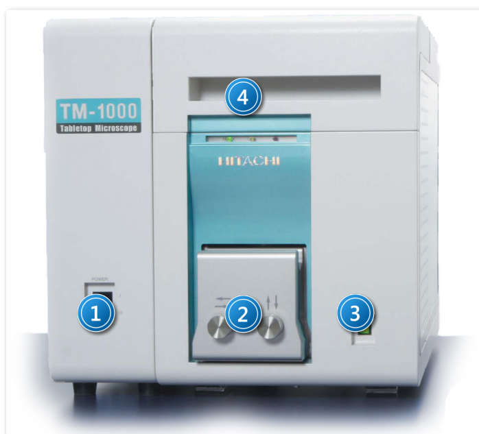
Zdjęcie 2. Widok frontu mikroskopu TM-1000: 1 – włącznik główny; 2 – front komory preparatowej; 3 – przycisk trybu pracy układu próżniowego; 4 – diody sygnalizujące stan próżni w komorze mikroskopu.
