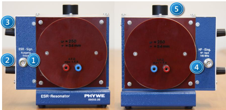
Zdjęcie 3. Widok wnęki rezonansowej EPR z lewej i prawej strony: 1 - wyjście sygnału EPR; 2 - pokrętko regulacji pojemności kondensatora C; 3 - pokrętko regulacji rezystancji R; 4 - wejście wysokiej częstotliwości; 5 - miejsce na próbkę.
