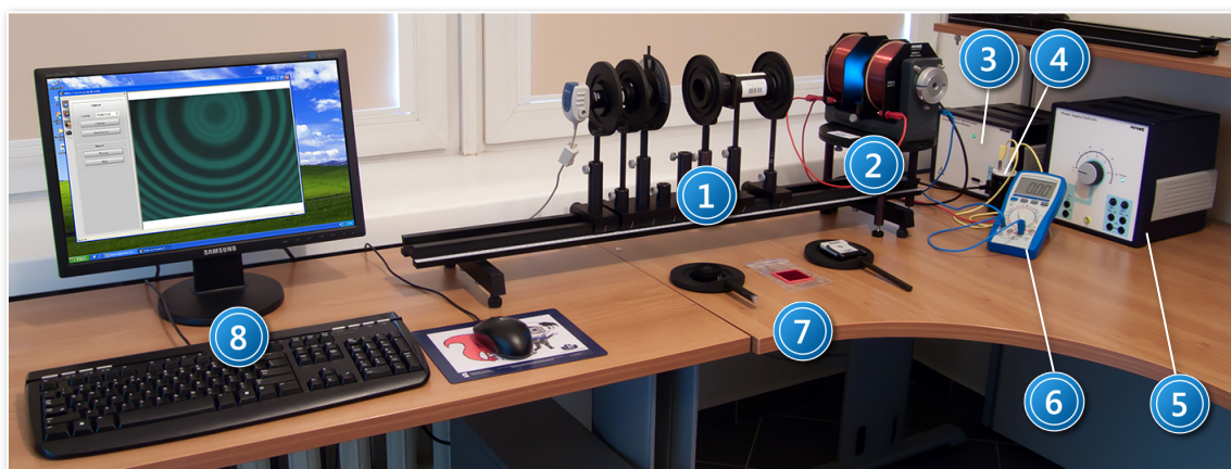
Zdjęcie 1. Stanowisko pomiarowe do badania efektu Zeemana: 1 – ława optyczna z elementami (od lewej do prawej): kamera CCD (w uchwycie), soczewka +50 mm, analizator, oprawa ćwierćfalówki, oprawa filtra zielonego, soczewka +300 mm, interferometr Fabry’ego – Pérota (z uchwycem na filtr czerwony), soczewka +50 mm; 2 – stolik obrotowy z elektromagnesem i lampą kadmową; 3 – zasilacz lampy; 4 – kondensator; 5 – transformator; 6 – multimetr cyfrowy (amperomierz); 7 – akcesoria (od lewej do prawej): filtr zielony w oprawie, filtr czerwony, ćwierćfalówka w oprawie; 8 – zestaw komputerowy.
