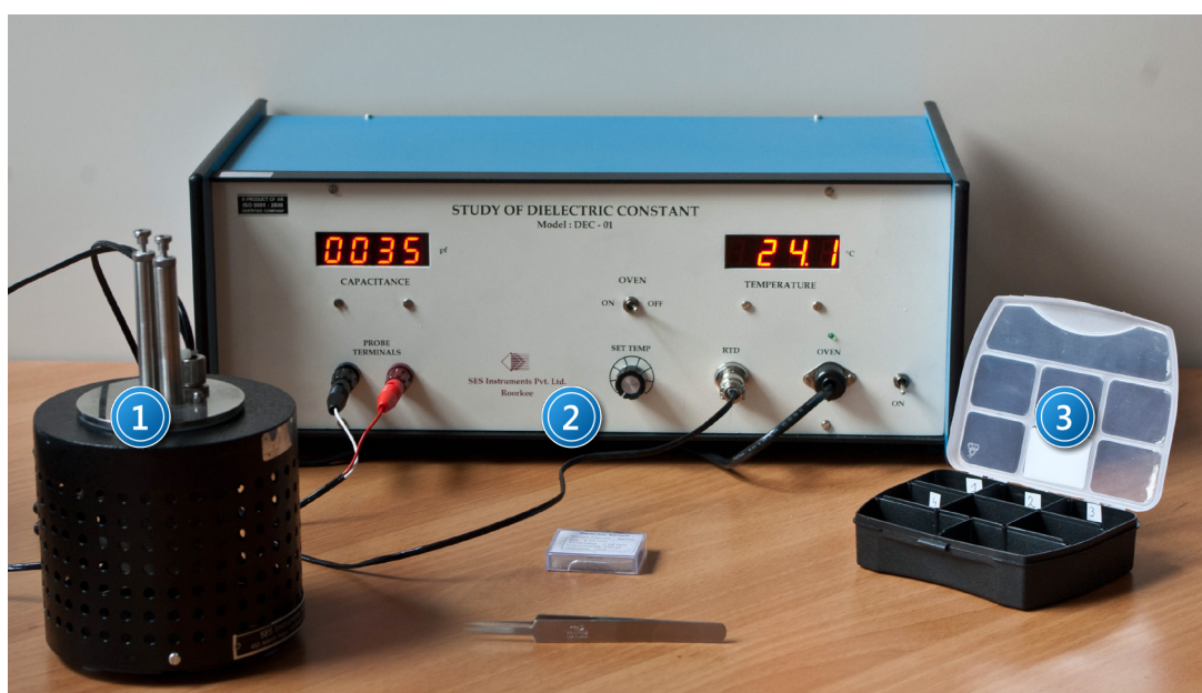
Zdjęcie 1. Układ do pomiaru stałej dielektrycznej ferroelektryków: 1 – piec grzewczy z kondensatorem; 2 – mostek RLC; 3 – zestaw próbek (kryształów ferroelektrycznych).
