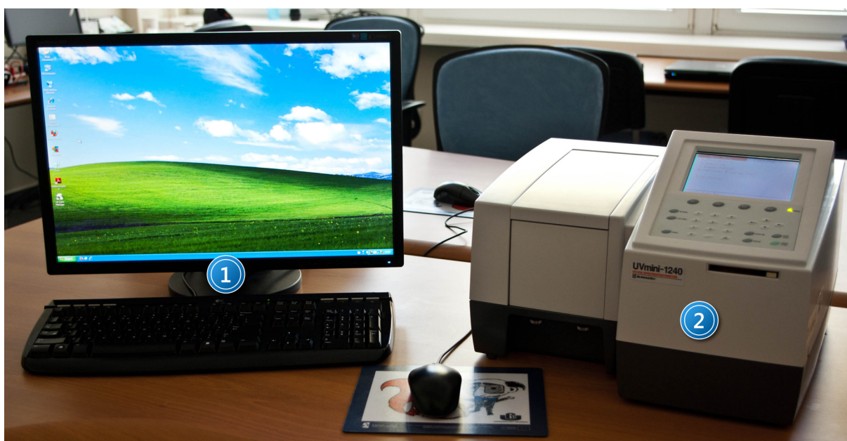
Zdjęcie 1. Stanowisko do pomiarów widm absorpcji: 1 – zestaw komputerowy; 2 – spektrofotometr UV - 1240.
