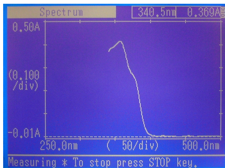
Zdjęcie 7. Ekran spektrofotometru podczas pomiaru widma absorpcji.
