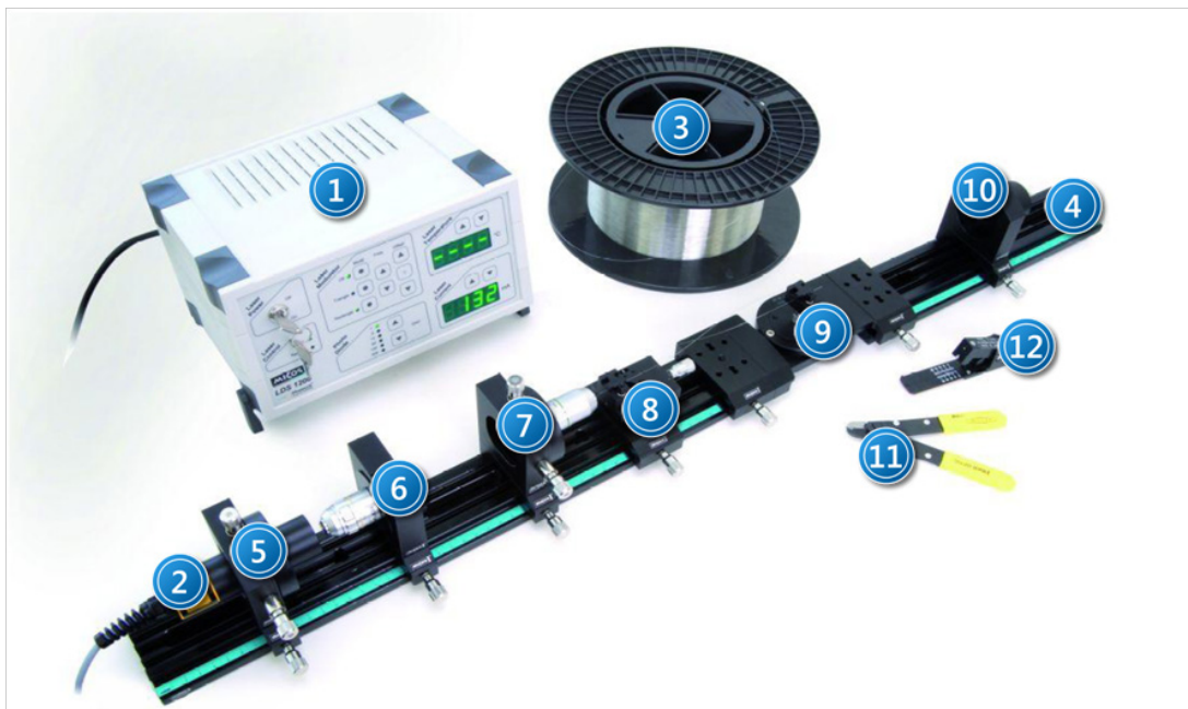
Zdjęcie 1. Układ pomiarowy do badania własności światłowodów: 1 – zasilacz wraz ze wzmacniaczem; 2 – laser; 3 – wójtka światłowodowa; 4 – ława optyczna; 5 – uchwyt lasera; 6, 7 – nastawne uchwyty wraz z soczewkami; 8, 9 – uchwyty magnetyczne do mocowania światłowodu; 10 – uchwyt z fotodiodą; 11 – ściągacz izolacji z włókien światłowodowych; 12 – narzędzie do nacinania światłowodów.
