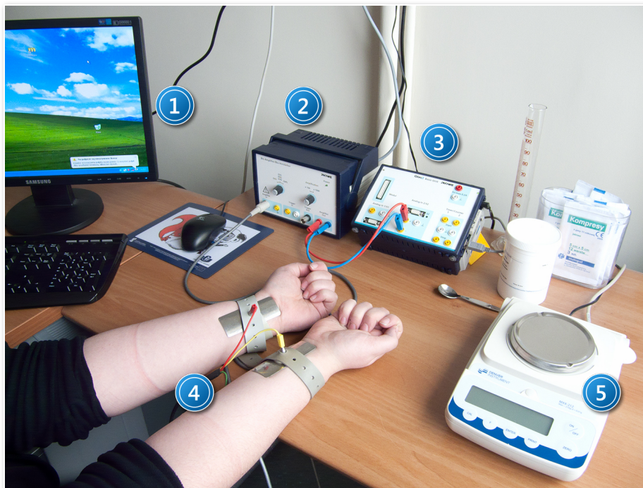
Zdjęcie 1. Stanowisko do rejestracji sygnałów EKG i FKG: 1 –zestaw komputerowy; 2 – wzmacniacz; 3 – moduł pomiarowy Cobra 3; 4 – elektrody EKG; 5 – waga.
