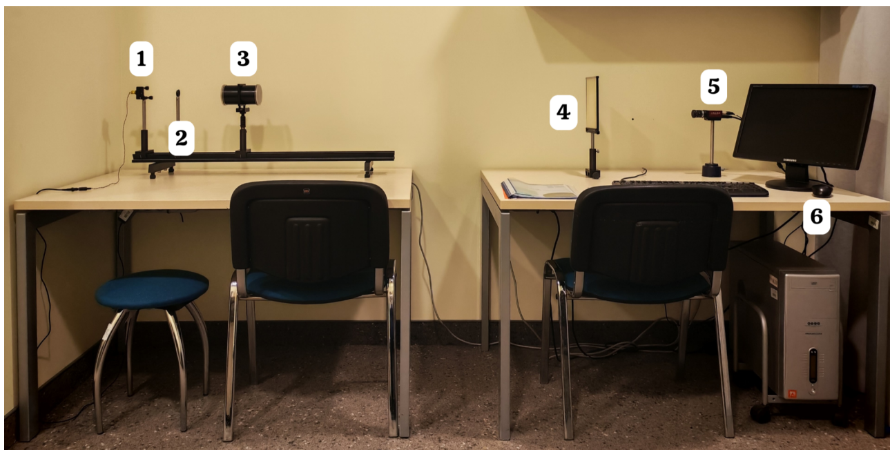
Rys. 1: Stanowisko do optycznej symulacji rentgenogramu DNA: 1 - laser, 2 - przysłona, 3 - slajd z siatkami dyfrakcyjnymi w uchwycie, 4 - ekran ze skalą pomiarową, 5 - kamera CCD, 6 - zestaw komputerowy.
