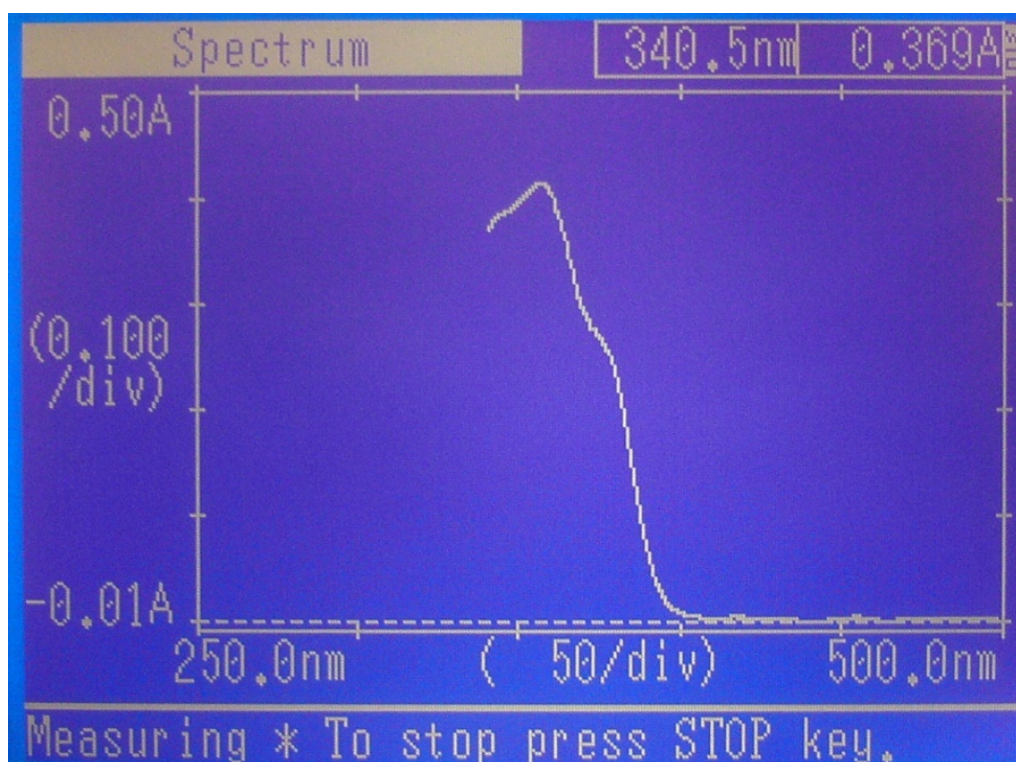
Rys. 6: Ekran spektrofotometru podczas pomiaru przykładowego widma absorpcji. U góry ekranu wyświetlana jest długość fali, dla której wykonywany jest pomiar.
