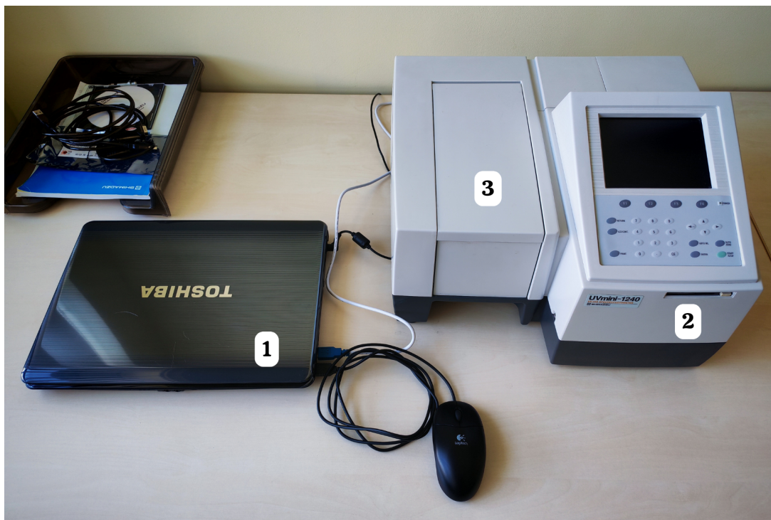
Rys. 1: Stanowisko do pomiarów widm absorpcji: 1 - laptop, 2 - spektrofotometr Shimadzu UVmini-1240, 3 - komora pomiarowa spektrofotometru.
