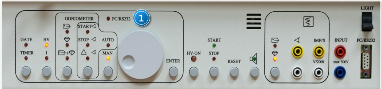
Zdjęcie 2. Widok panelu sterującego modułem rentgenowskim: 1 – pokrętko wyboru wartości parametrów pomiarów.
