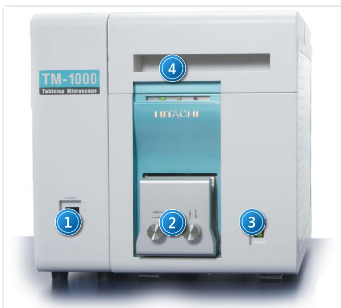
Zdjęcie 2. Widok frontu mikroskopu TM-1000: 1 – wyłącznik główny; 2 – front komory preparatowej; 3 – przycisk trybu pracy układu próżniowego; 4 – diody sygnalizujące stan próżni w komorze mikroskopu.
