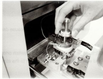
Zdjęcie 4. Montaż stolika w komorze mikroskopu.
