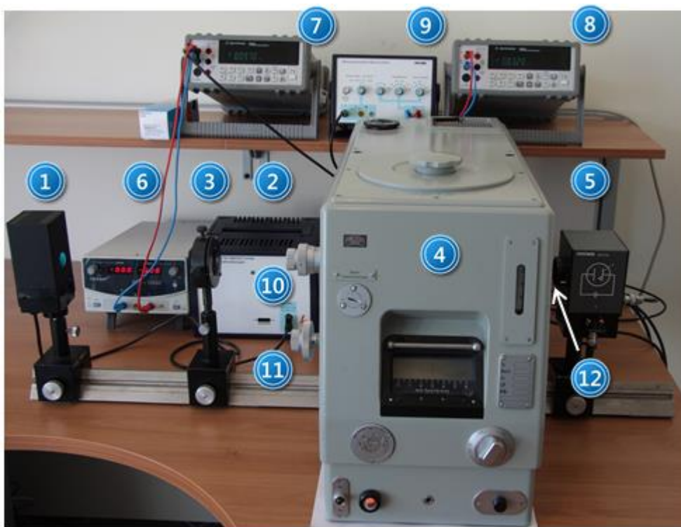
Zdjęcie 1. Stanowisko do wyznaczania stałej Plancka: 1 – lampa Hg-Cd; 2 – zasilacz lampy; 3 – soczewka; 4 – monochromator; 5 – fotokomórka Sb-Cs; 6 – zasilacz fotokomórki; 7, 8 – woltomierze; 9 – wzmacniacz; 10, 11 – pokręta szerokości szczeliny oraz zmiany długości fali; 12 – przesłona.
