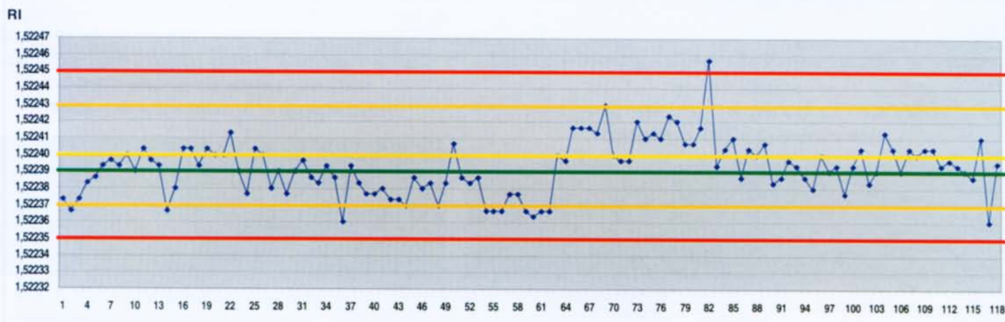
Ryc. 41. Wykres wyników pomiarów RI szkła wzorcowego od 23.04.2002 r. do 3.03.2004 r. opracowany na podstawie karty Shewarta Fig. 41. Results of RI measurements of glass standard (from 23-04-2002 to 03-03-2004) developed basing on Shewart's cart
