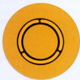
Ryc. 45. Prawidłowo wycentrowana kondensorowa przysłona pierścieniowa z pierścieniem fazowym obiektywu
