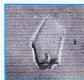
Ryc. 46. Nieprawidłowo wycentrowana kondensorowa przysłona pierścieniowa z pierścieniem fazowym obiektywu
