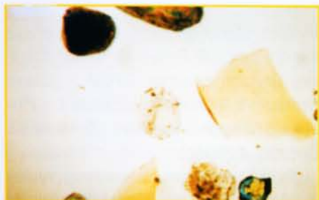
Ryc. 30. Obraz mikroskopowy piasku i szkła (nikole są równoległe). Drobiny szkła dobrze widoczne
