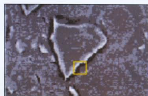
Ryc. 44. Szkiełko i olejek poniżej temperatury równowagi (linia biała po stronie wewnętrznej a czarna po zewnętrznej)
