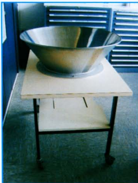
Ryc. 28. Stalowy lejek stosowany w BKA (Wiesbaden) do zbierania wytrzepin z odzieży Fig. 28. Steel funnel used in BKA (Wiesbaden) for collection of shaken off clothes particles
