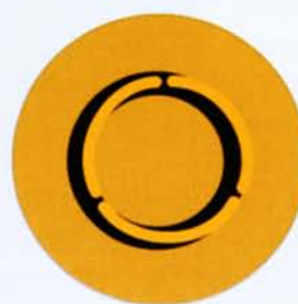
Ryc. 46. Nieprawidłowo wycentrowana kondensorowa przysłona pierścieniowa z pierścieniem fazowym obiektywu
