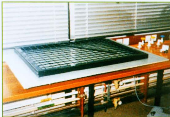
Ryc. 29. Stalowa krata wykorzystywana w NFI (Rijswijk) do zbierania wytrzepin z odzieży Fig. 29. Steel crate used in NFI (Rijswijk) for collection of shaken off clothes particles
