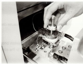
Zdjęcie 4. Montaż stolika w komorze mikroskopu.
