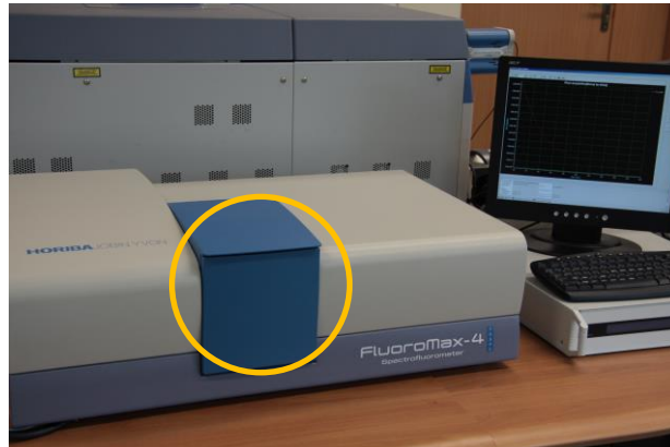
Zdjęcie 1 Układ pomiarowy z zaznaczoną komorą pomiarową.
