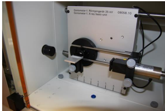
Zdjęcie 2. Sposób umieszczania próbki LiF w dyfraktometrze.
