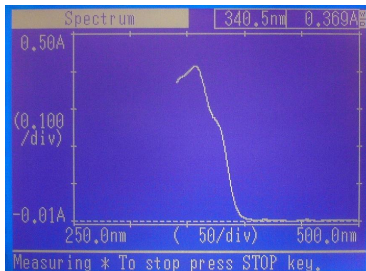
Zdjęcie 6. Ekran spektrofotometru podczas pomiaru widma absorpcji.
