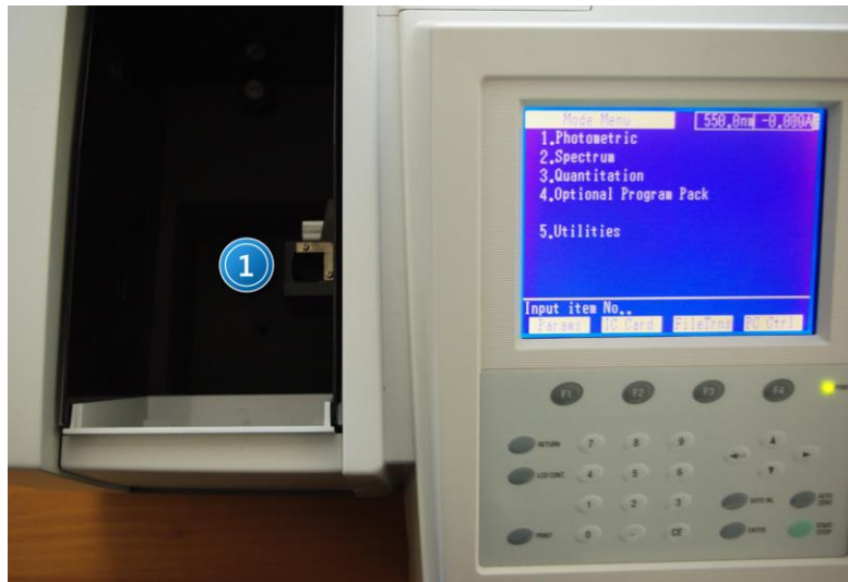
Zdjęcie 5. Widok otwartej komory na próbki spektrofotometru: 1 – uchwyt na kuwety.
