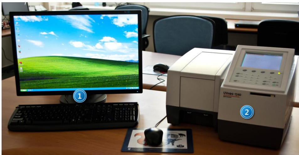
Zdjęcie 1. 1. Zestaw komputerowy 2. Spektrofotometr Shimadzu UVmini-1240.
