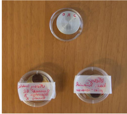
Zdjęcie 1. Przykładowy materiał dowodowy do badań przy użyciu skaningowego mikroskopu elektronowego: ślady narzędzi, włosy zwierzęce i ludzkie.
