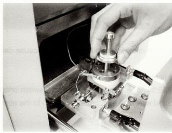
Zdjęcie 4. Montaż stolika w komorze mikroskopu.
