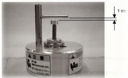
Zdjęcie 3. Próbnik wysokości stolika z preparatem.
