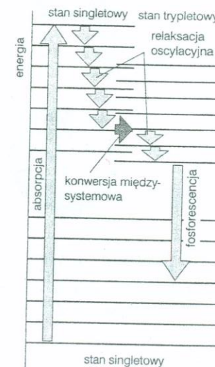
Rys. 11.42. Kolejne etapy fosforescencji. Zasadniczym etapem jest konwersja międzysystemowa prowadząca ze wzbudzonego stanu singletowego do wzbudzonego stanu trypletowego. Stan trypletowy działa jak powoli opróżniany zbiornik energii promienistej, gdyż powrót z niego do stanu podstawowego przebiega bardzo powoli
