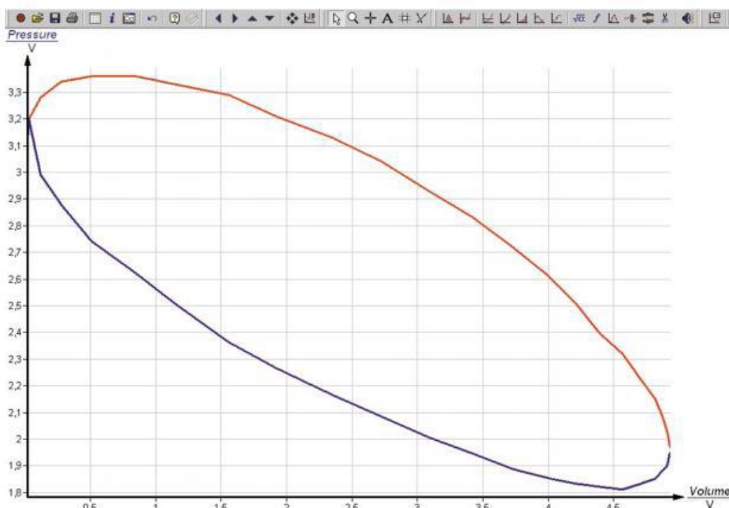
Rys.3 Ciśnienie w funkcji objętości w rzeczywistym, zamkniętym cyklu Stirlinga.
