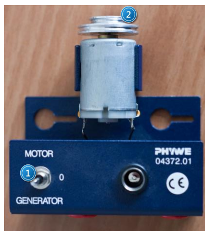
Zdjęcie 9. Moduł generatora: 1 – przełącznik trybu pracy; 2 – koła pasowe na generatorze.
