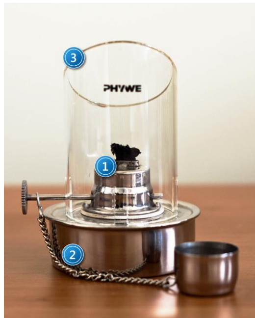
Zdjęcie 3. Palnik: 1 – nakrętka palnika; 2 – zbiornik palnika; 3 – komin palnika.
