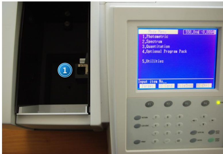
Zdjęcie 5. Widok otwartej komory na próbki spektrofotometru: 1 – uchwyt na kuwety.
