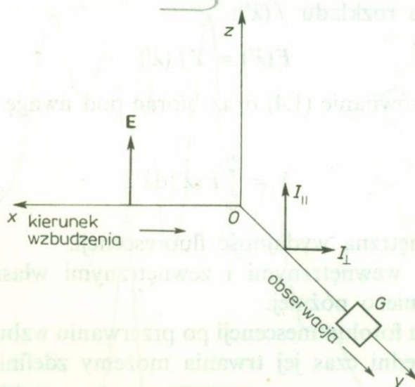
Rys. 1.2. Schemat obserwacji przy pomiarach anizotropii emisji. Badany roztwór jest umieszczony w początku układu współrzędnych O . Fluorescencję obserwuje się wzdłuż kierunku y . Natężenia I_{\parallel} i I_{\perp} mierzy się po przejściu światła fluorescencji przez pryzmat Glana G dla dwóch położeń względem wektora elektrycznego E światła liniowo wzbudzającego
