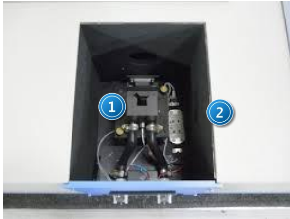
Zdjęcie 2. Widok wnętrza komory pomiarowej: 1 – uchwyt do ciekłych; 2 – miejsce na filtr w torze emisyjnym.
