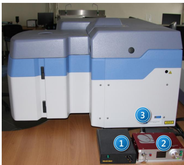
Zdjęcie 2. Układ pomiarowy – widok z boku: 1 - zasilacz lasera He-Ne; 2 - zasilacz lasera YAG:Nd; 3 - spektrometr Ramana.
