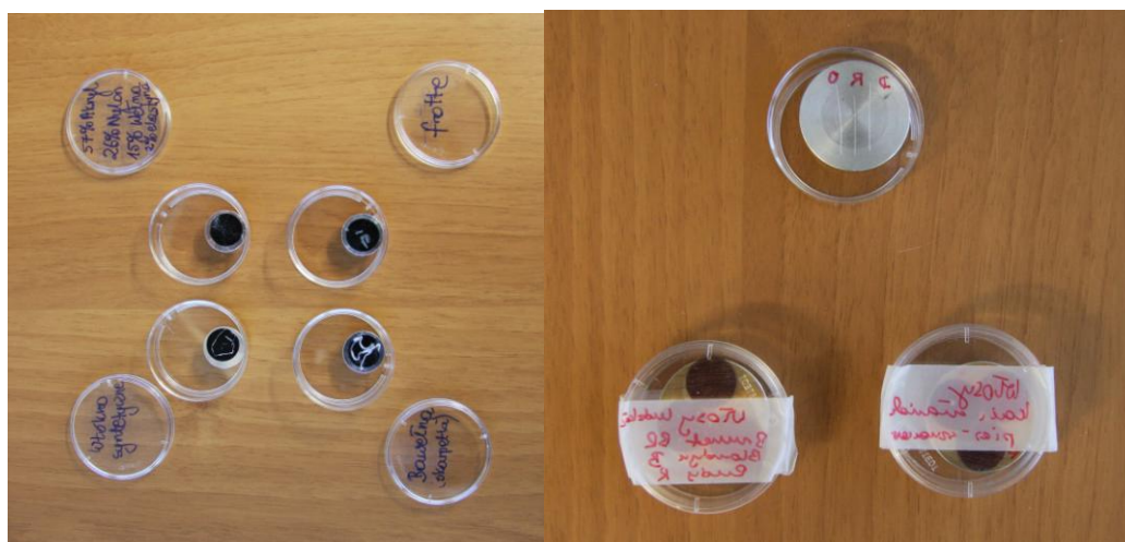
Zdjęcie 2. Przykładowy materiał dowodowy do badań przy użyciu mikroskopu stereoskopowego: różnego rodzaju włókna, ślady narzędzi, włosy zwierzęce i ludzkie.
