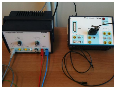
Zdjęcie 3. Układ pomiarowy do rejestracji sfigmogramu.
