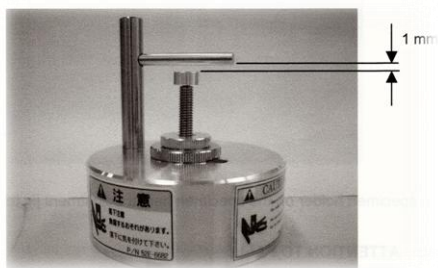
Zdjęcie 3. Próbnik wysokości stolika z preparatem.
