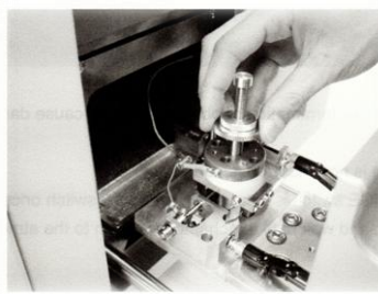
Zdjęcie 4. Montaż stolika w komorze mikroskopu.
