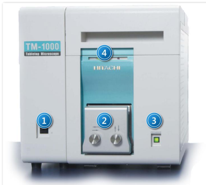
Zdjęcie 1. Widok frontu mikroskopu TM-1000: 1 – wyłącznik główny; 2 – front komory preparatowej; 3 – przycisk trybu pracy układu próżniowego; 4 – diody sygnalizujące stan próżni w komorze mikroskopu.
