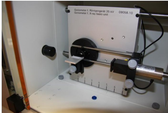
Zdjęcie 2. Sposób umieszczania próbki LiF w dyfraktometrze.
