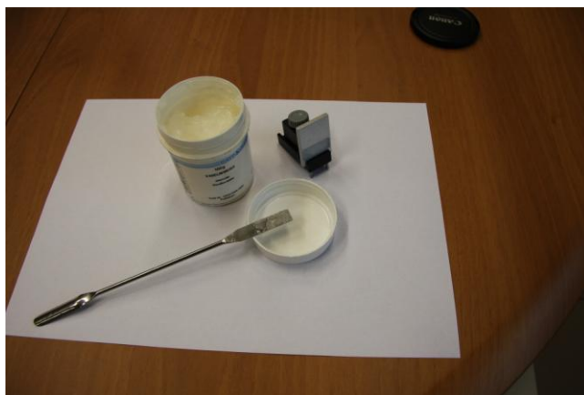
Zdjęcie5. Uchwyt do badania próbek w postaci proszku.
