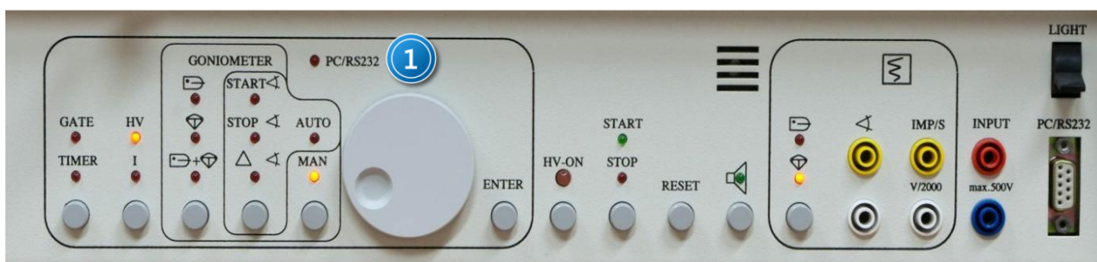
Zdjęcie 2. Widok panelu sterującego modułem rentgenowskim: 1 – pokrętło wyboru wartości parametrów pomiarów.
