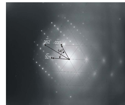
Rys. 4.13. Dyfraktogram z ziarna ferrytu zawierającego wydzielenie węgla Cr_{23}C_6 . Mikroskop transmisyjny (TEM)
