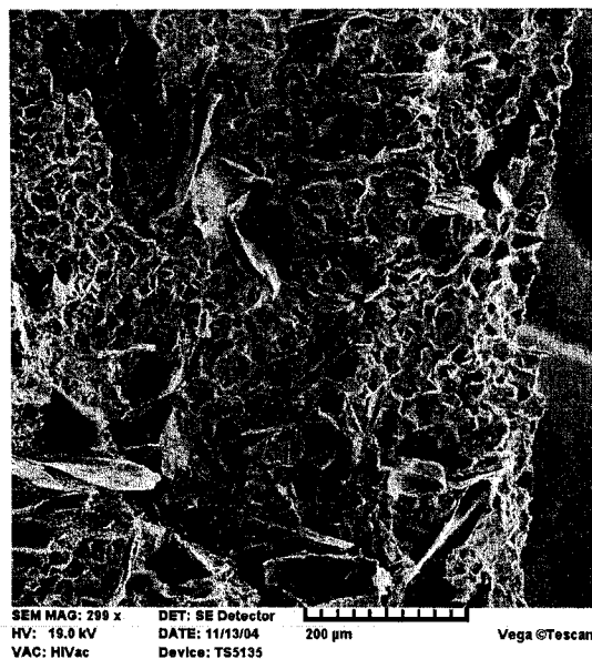
Rys. 8.6. Przełom żeliwa szarego hartowanego indukcyjnie
