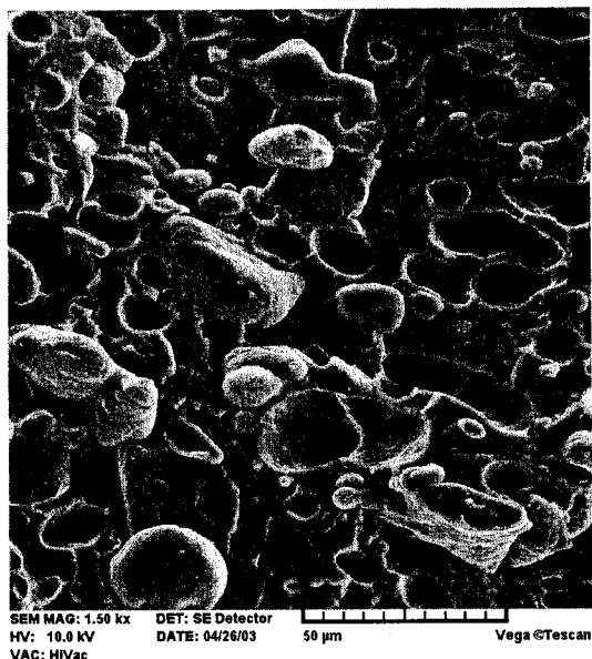
Rys. 8.5. Przełom kompozytu tworzywa i pyłów
